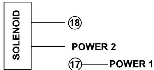
MAKE SURE TO MATCH POWER VOLTAGE TO LOCK RATING (17 & 18 ARE NORMALLY OPEN CONTACTS, 10 AMP RATING)
